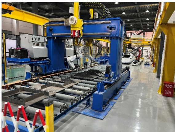
图7 智能小组立焊接系统
